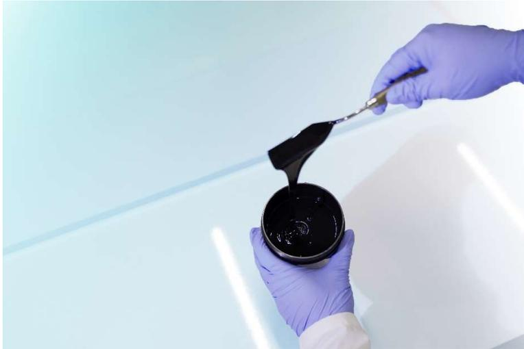
In Kombination mit silberhaltigen und dielektrischen Lacken ermöglicht die innovative PTC-Technologie (Positive Temperature Coefficient) von Henkel die Herstellung von selbstregulierenden Folienheizungen.
