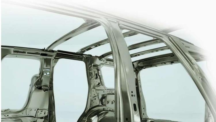
Strukturklebstoffe von Henkel, die z. B. bei der Montage von Kabinen das Schweißen ersetzen, können Gewicht und Materialverbrauch reduzieren und den CO<sub>2</sub>-Fußabdruck um bis zu 15 Prozent verringern.
