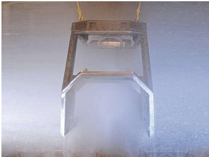
Die Innovationen von Henkel im Bereich Reinigung und Metallvorbehandlung ermöglichen eine Niedrigtemperaturreinigung bei 38°C statt 60°C und damit eine erhebliche Energieeinsparung.
