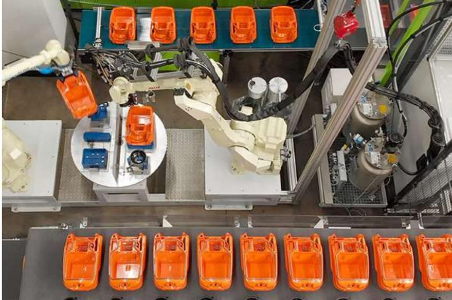
Der 6-Achsroboter legt das Staubsauger- und Motortopfgehäuse für den Dosierauftrag in einem Schritt auf den Rundtakttisch-Teileaufnahmen ab.
